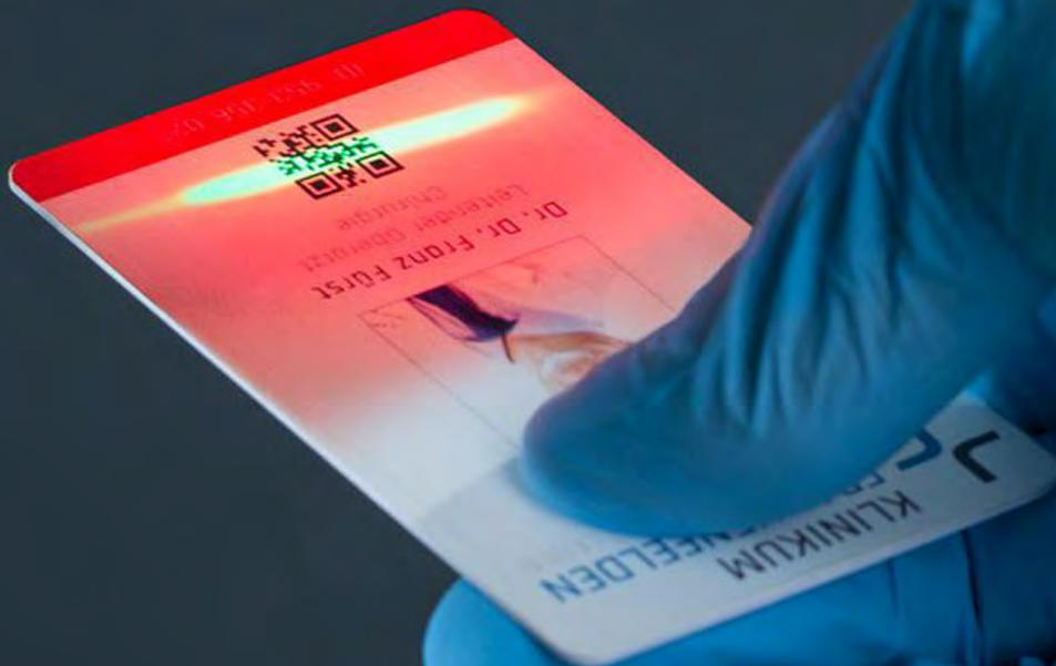
Un lecteur de codes à barres est disponible en option. Cela permet de lire les codes à barres 1D (EAN, UPC, et IAN par exemple) ainsi que les codes à barres 2D, appelés codes QR.
